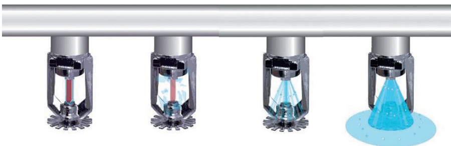
Funktionsweise einer Sprinkleranlage im Überblick.
